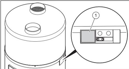
Die Typenbezeichnung und die Seriennummer befinden sich auf dem Typenschild (1).
