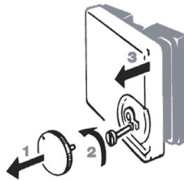
Der Regler darf nur auf nicht leitendem Untergrund montiert werden. Positionieren Sie den Thermostat so, dass er nicht von Gardinen, Möbelstücken oder anderen Gegenständen verdeckt wird. Der Regler darf auch nicht in unmittelbarer Nähe von Wärmequellen installiert werden (z.B. Lampen, Kamin, direkte Sonneneinstrahlung etc.) und sollte nicht von Zugluft beeinträchtigt werden. Nur so kann er die Raumtemperatur genau erfassen und entsprechend exakt regeln.
